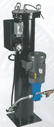
FSLVAW - Nagy hatékonyságú szemcse eltávolítás (< 0.7m). Eltávolítja a vizet, a nem oldódó iszapot és a lakkot.
