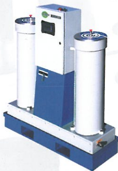
ECR - Elektrosztatikus szennyeződés eltávolító, eltávolítja a hőlebmolás során keletkezett szubmikron részecskéket.
